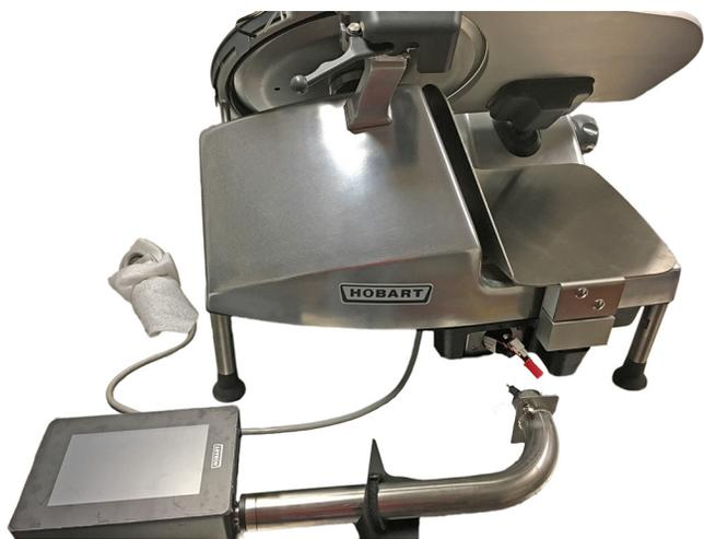
2. Connectez les fils du bras de l'écran aux fils provenant de la trancheuse (HS6-1PS illustré, HS7-1PS possède 4 fils).
