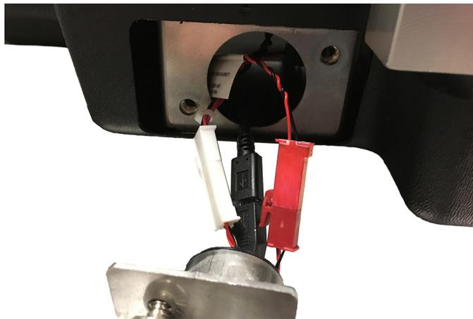
3. Insérez doucement le tube du bras de l'écran dans la trancheuse tout en insérant l'excès de fil à l'intérieur de la trancheuse.
