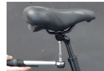
cf. 1. Dévisser la vis de serrage
