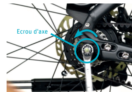
cf. 4. Desserer l'écrou d'axe
