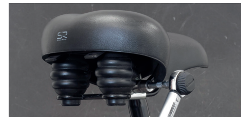
cf. 1. Dévisser l'écrou de serrage
