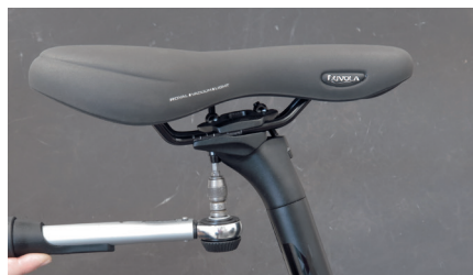
zu 1. Schrauben lösen
