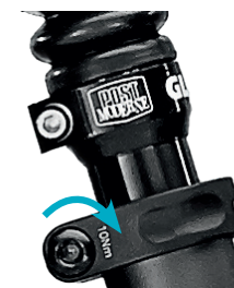
zu 3. Sattelschraube(n) festziehen
