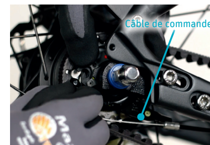
cf. 3. Démontez le câble de commande de la roue arrière
