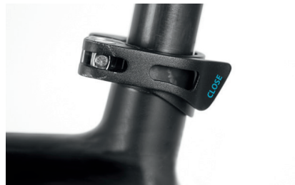
zu 2. Schnellspannhebel geschlossen
