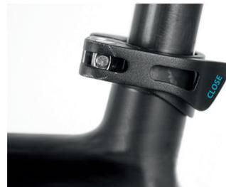
zu 2. Schnellspannhebel geschlossen
