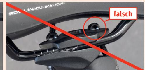
1. Um den Sattel zu verschieben, vordere und hintere Schraube lösen, indem Sie diese gegen den Uhrzeigersinn drehen. Drehen Sie die Schrauben höchstens zwei bis drei Umdrehungen auf, sonst kann der gesamte Mechanismus auseinanderfallen.
