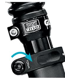
zu 3. Sattelschraube(n) festziehen
