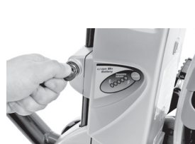
► Sbloccaggio della batteria
