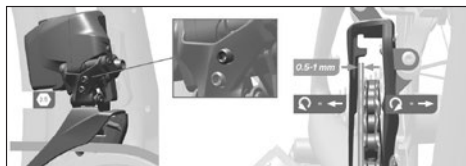
Afb. 96 Bovenste aanslag instellen ©Sram
