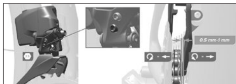
Afb. 97 Bovenste aanslag instellen ©Sram
