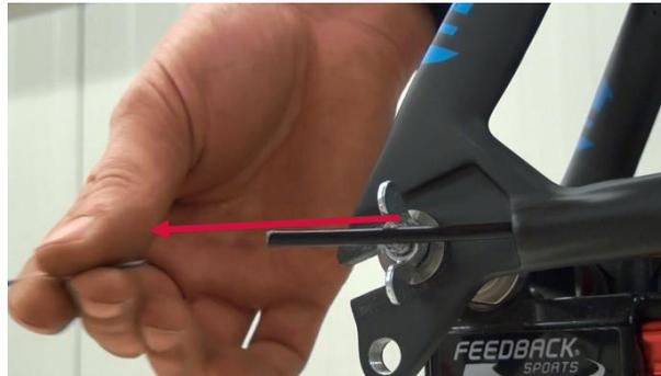
10. Schalthülle mithilfe des Hilfskabels aus der Kettenstrebe ziehen.
