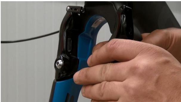
12. Den zweiten Bremsarm vormontieren.
