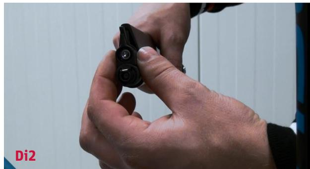
Legen Sie – optional – die Shimano Di2-Batterie und den Di2-Klemmkonus in die Sattelstütze.
