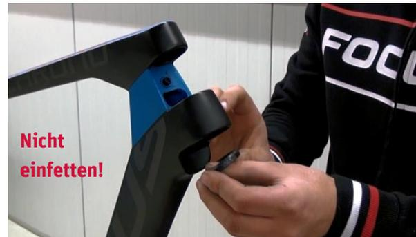
3. Das untere Steuerlager einsetzen.
