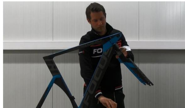
9. Gabel von unten durch Steuerrohr und Vorbau schieben.
