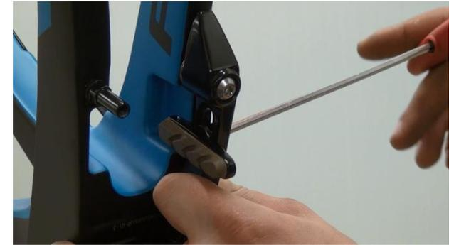
5. Bremsbelag ausrichten und mit 5 Nm befestigen.
