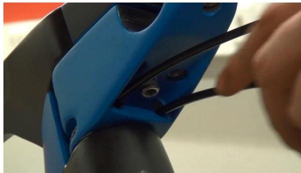
12. Die zweite Schaltzughülle durch die linke Vorbauöffnung fädeln. Den Schaltzug durch das Unterrohr bis ins Tretlager fädeln.
