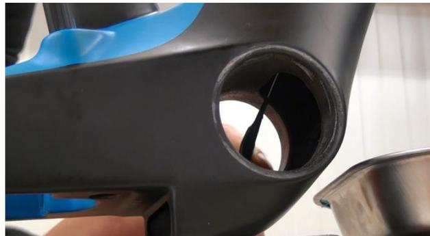
7. Hilfskabel mit dem Hakenwerkzeug aus dem Unterrohr holen.
