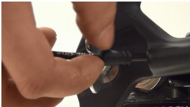
11. Gummi-Plug auf die Schalthülle setzen und samt Schalthülle in die Kettenstrebe stopfen.
