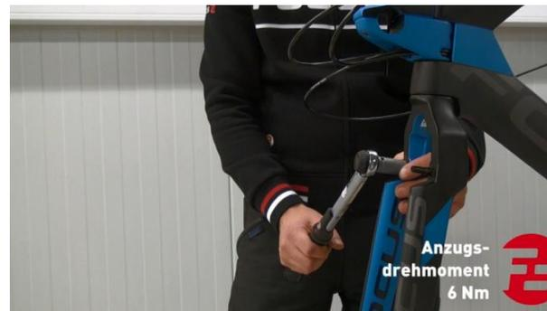
1. Alle Cantilever Bremssockel mit 6 Nm an Rahmen bzw. Gabel festschrauben.
