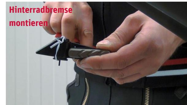
2. Mit der Montage der rechten Bremse beginnen. Dadurch ergibt sich eine bessere Zugänglichkeit. Bremsbelag vorher abmontieren.
