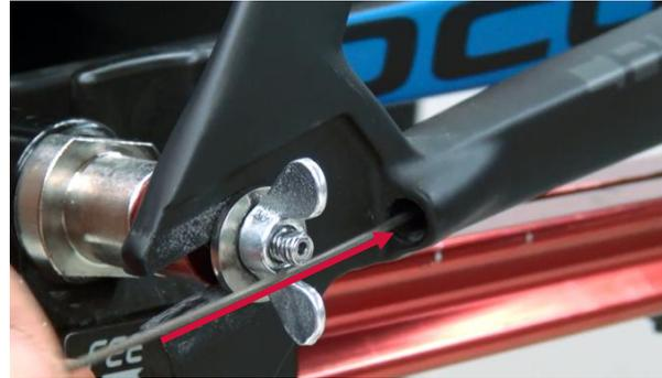
6. Hilfskabel von hinten rechts in die Kettenstrebe schieben.
