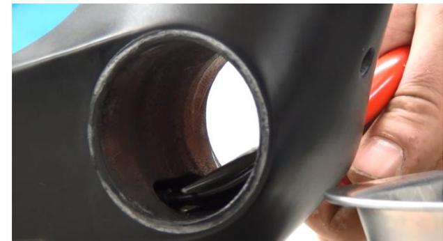
13. Die Schalthülle auf die Zugumlenkung stecken. Eine Spitzzange zur Hilfe nehmen.
