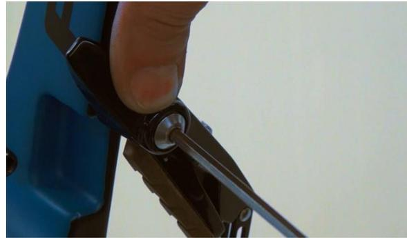
4. Zur Einhängung der Vorspannfeder hier die äußere Position (Bohrung in Kettenstrebe) verwenden. Äußere Position bewirkt höhere Gesamtspannung (= besseren Wirkungsgrad) in der Hinterradbremse. Bremse mit 6 Nm festschrauben.
