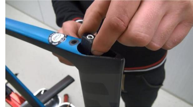
3. Klemmkonus ins Oberrohr legen. Tipp: Rahmen dabei etwas nach vorne kippen - dadurch wird verhindert, dass der Klemmkonus in den Rahmen fällt.
