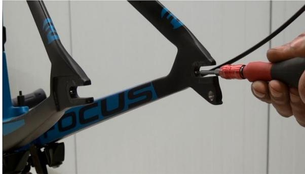
1. Je nach Reifendicke/ zur Einstellung Hinterrad (Parallelität) Stellschrauben auf beiden Seiten einstellen.
