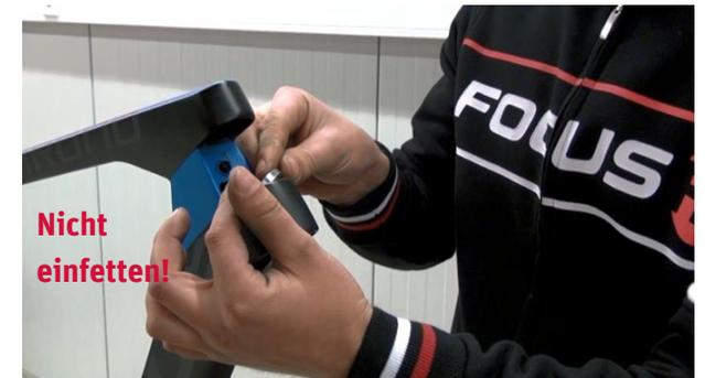
4. Das obere Steuerlager einsetzen.
