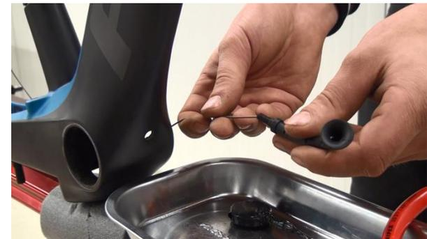
2. Zugumlenkung auf den Hilfsdraht setzen.
