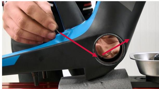
1. Hilfsdraht durch Öffnung in Kettenstrebe bis zum Tretlager schieben.
