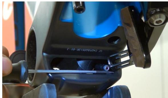
7. Bremszughülle bis unten in die Tretlageröffnung schieben. Mit Hilfe eines Hakenwerkzeugs herausholen.
