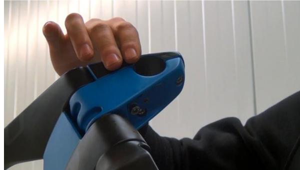
12. Lenkeinschlagbegrenzung kontrollieren: Vorbau links und rechts bis zum Anschlag drehen. Der Lenkereinschlag beträgt auf beiden Seiten 45°.
