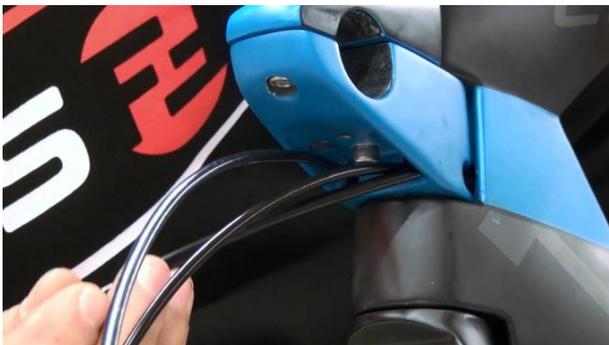
6. Bremszughülle vorne durch die linke Öffnung im Vorbau schieben. Dabei den Vorbau zur rechten Seite drehen.
