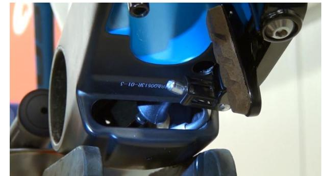
8. Pipe auf die Bremszughülle setzen. Tipp: mit Spitzzange die Pipe etwas zusammendrücken damit sie stramm auf der Bremshülle sitzt und später nicht abrutscht. Danach die Bremszughülle leicht ins Tretlagergehäuse zurückbewegen. Die Pipe in die Bremse einhängen.
