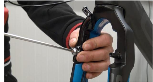
11. Vorspannfeder einhängen (Hilfswerkzeug verwenden, Haken o.ä.) und Bremsarm anschrauben (6 Nm). Hier Einhängposition für Feder je nach Gefühl/ Vorliebe wählen (innere Position: weniger stramm, äußere Position: strammere Vorspannung)
