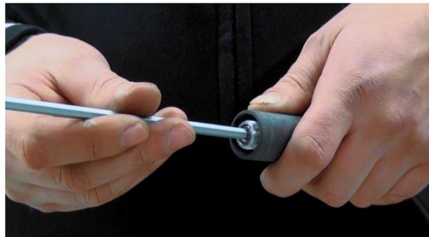
2. Die Kompressorkappe abschrauben und den Kompressor mit maximal 8 Nm festschrauben. Bitte darauf achten, dass der Kompressor zentriert im Gabelschaft sitzt und oben bündig abschließt.
