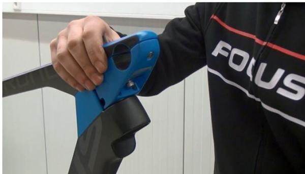
8. Vorbau ins Steuerrohr schieben. Der Zahn des Alu-Rings muss in die Vorbautasche greifen.
