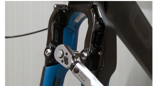
14. Bremsarme mit 6 Nm festziehen bzw. Drehmomente kontrollieren.
