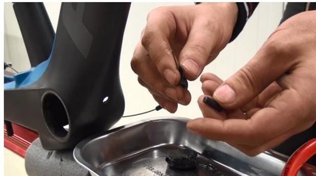
3. Zugendkappe auf den Hilfsdraht setzen und bis Anschlag in die Trompetenöffnung der Zugumlenkung schieben.
