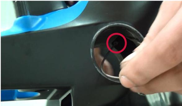
9. Schalthülle und Hilfskabel auf Höhe des Tretlagers verbinden.
