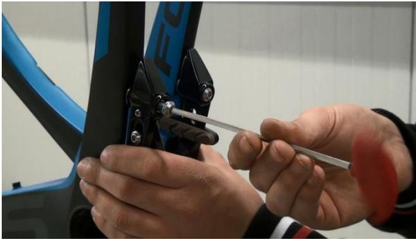
9. Den linken Bremsarm anschrauben, Anzugsmoment 6 Nm.
