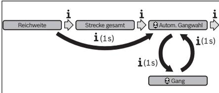
Durch Drücken der Taste „i“ für mehr als 1 s haben Sie die Möglichkeit, zwischen dem automatischen Modus „**Autom. Gangwahl**“ und dem manuellen Modus „**Gang**“ hin- und herzuschalten.
