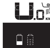
Werden an einem eBike mit zwei eingesetzten Akkus beide Akkus am Fahrrad geladen, so wird auf dem Display der Ladefortschritt der beiden Akkus angezeigt (in der Abbildung wird gerade der linke Akku geladen). Welcher der beiden Akkus gerade geladen wird, können Sie an der blinkenden Anzeige am Akku erkennen.
