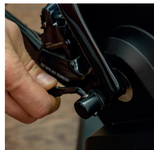
7. Zieh die TACX-Schnellspan-nachse von Hand fest.
