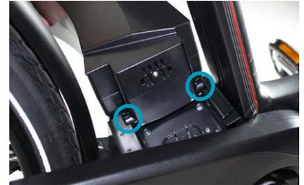
3. Den Akku nach vorne/oben in die Dockingstation schieben, bis die Verriegelung einrastet.
