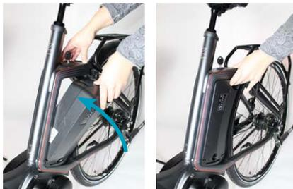
4. Den Akkuschlüssel aus dem Akkus Schloss ziehen. Nun ist der Akku verriegelt.
