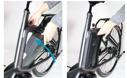
4. Den Akkuschlüssel aus dem Akkus Schloss ziehen. Nun ist der Akku verriegelt.
