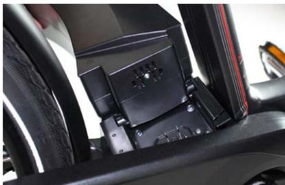
3. Den Akku nach vorne/oben in die Dockingstation schieben, bis die Verriegelung einrastet.
