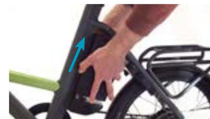
Punto 5 Saque la batería de la estación de acoplamiento
