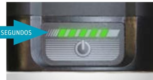
Indicación del estado de carga de la batería
