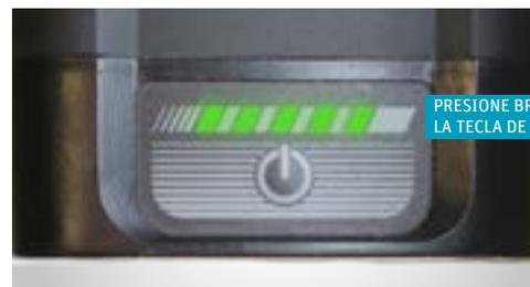
Indicación del estado de carga de la batería
