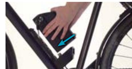
Punto 2 Sostener la batería en la estación de acoplamiento
