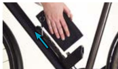
Punto 2 Sacar la batería de la estación de acoplamiento
