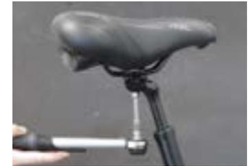
Punto 1 Aflojar el tornillo de fijación
