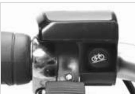
Schaltfläche für die Schiebehilfe
