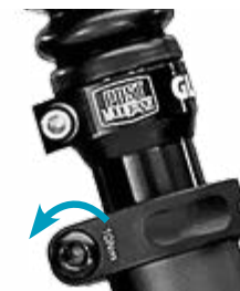
Punto 1 Aflojar el/los tornillo(s) del sillín
