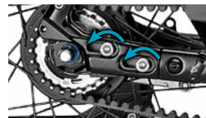
Punto 2 Aflojar los tornillos
