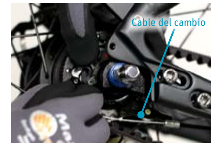
Punto 3 Afloje el cable del cambio de la rueda trasera
