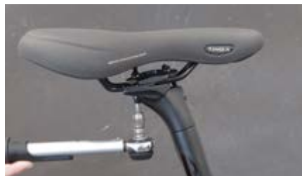
Punto 1 Aflojar los tornillos
