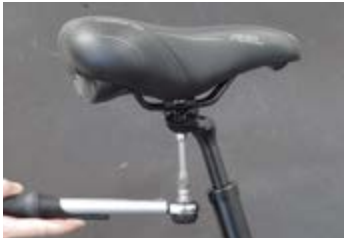
Punto 1 Aflojar el tornillo de fijación
