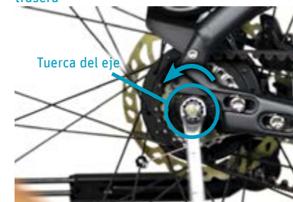
Punto 4 Afloje las tuercas del eje
