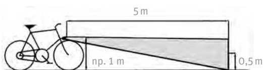
Ustawienie przedniego reflektora
