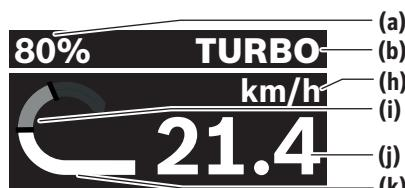
(a) Livello di carica della batteria della eBike (configurabile)
