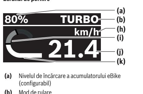
**(a)** Nivelul de încărcare a acumulatorului eBike (configurabil)
