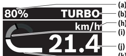
(a) eBike-akkumulátor töltöttségi állapota (konfigurálható)
