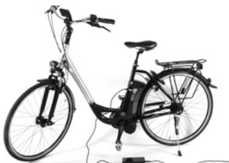
BATTERIET PÅ SETERØRET Lading av batteriet
