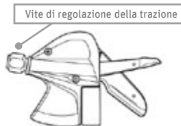
Fig. 83 Modifica della tensione di trazione ©Shimano
