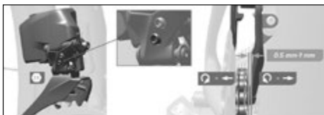
Afb. 97 Bovenste aanslag instellen ©Sram
