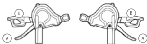
Vľavo: Predný preradovací mechanizmus (vpredu) Vpravo: Zadný preradovací mechanizmus (vzadu) Obr. 67 Páčka prehadzovačky Shimano Standard ©Shimano
