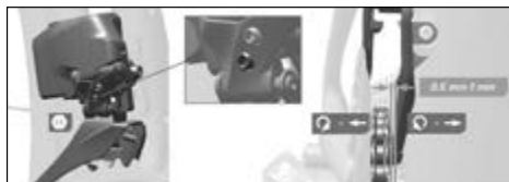
Rys. 97 Ustawianie górnego ogranicznika ©Sram
