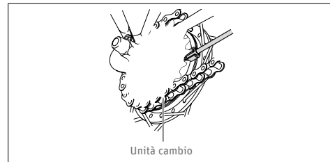
Fig. 129 Consiglio per rimozione guaina dei cavi ©Shimano
