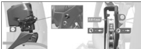
Fig. 96 Regolazione arresto superiore ©Sram
