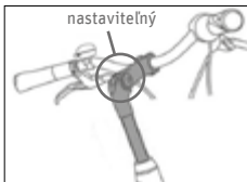
Obr. 27 Predstavce s hriadeľom s nastaviteľným sklonom
