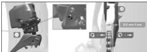
Fig. 97 Regolazione arresto superiore ©Sram
