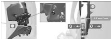
Kuva 97 Ylemmän rajoittimen säätäminen ©Sram
