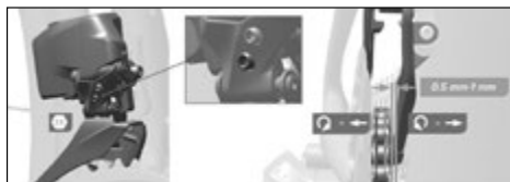
Fig. 97 Ajustar el tope superior ©Sram
