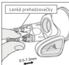
Obr. 106 Jemné potiahnutie laniek prehadzovačky ©Shimano
