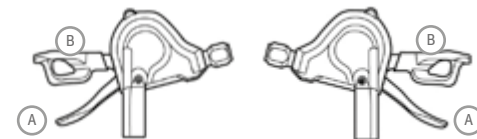
A sinistra: Deragliatore (anteriore) A destra: Deragliatore (posteriore)
