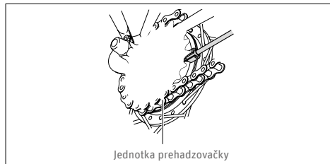
Obr. 129 Típ: odstránenie puzdra kábla ©Shimano
