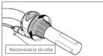
Obr. 100 Otočná rukoväť prehadzovačky Shimano Standard ©Shimano
