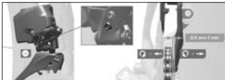
Fig. 97 Justering av øvre anslag ©Sram
