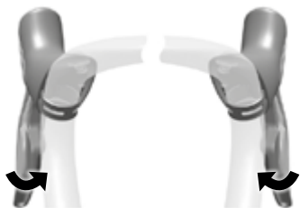
Fig. 79 Maneta de cambio eTap AXS de Sram ©Sram
