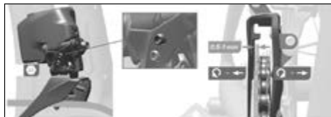
Rys. 96 Ustawianie górnego ogranicznika ©Sram
