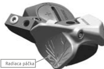
Obr. 78 Páčka prehadzovačky Sram Eagle AXS ©Sram
