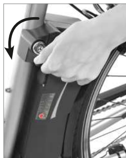
Entriegeln der Batterie
