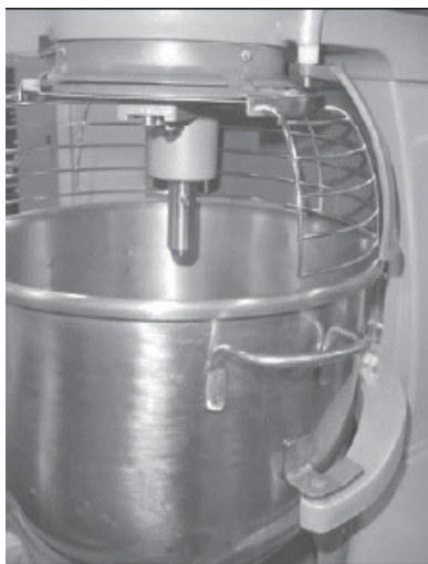
Grilles de protection pour batteurs-mélangeurs de 12 ptes et de 20 ptes
