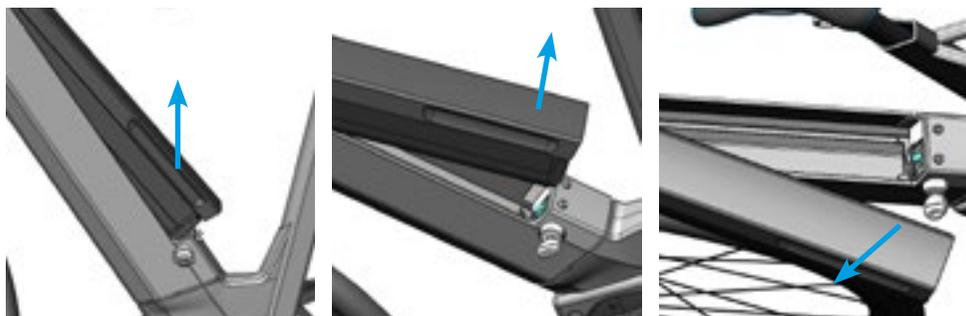
3. Schlüssel im Uhrzeigersinn drehen und abziehen.
