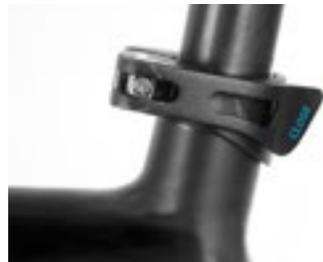
zu 2. Schnellspannhebel geschlossen
