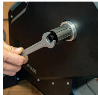
3. Apretar el espaciador (2a) en el lado de la transmisión.
