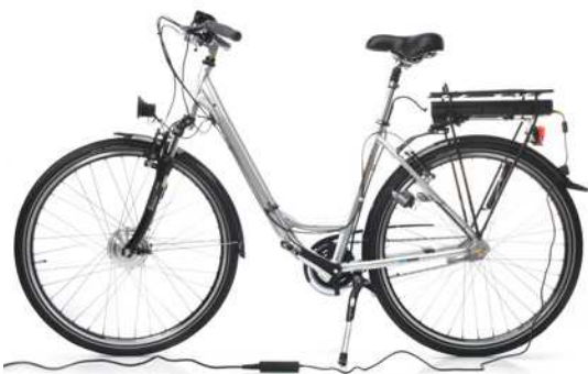
Aufladen der Batterie
