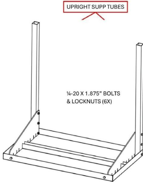
6. ROTATE OVERSHELF TO UPRIGHT POSITION AND ALIGN WITH SIDE SUPP BRACKETS.
