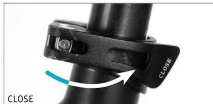
Chiudere la leva di bloccaggio
