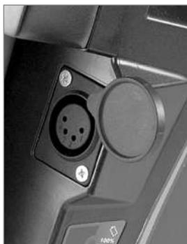
3. Poi inserire la spina a quattro poli del caricabatteria nella presa di carica della batteria.
