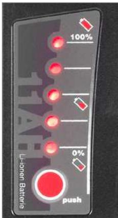
Visualizzazione del livello di carica e della capacità della batteria
