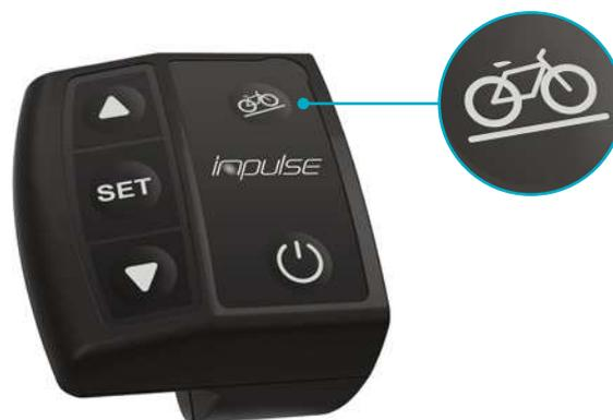
Il dispositivo di spinta ausiliaria fa procedere la Pedelec lentamente ad una velocità massima di 6 km/h senza che si debba pedalare, ad es. quando si manovra in uno spazio limitato o si tira fuori la Pedelec da un garage sotterraneo.
