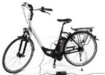
BATÉRIA NA SEDLOVEJ RÚRKE RÁMU Nabíjanie batérie
