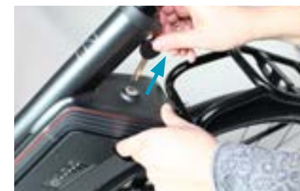
Punto 4 Bloquear la batería
