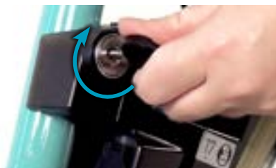
Punto 4 Bloquear la batería
