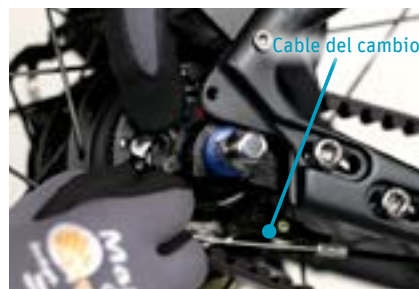
Punto 3 Afloje el cable del cambio de la rueda trasera
