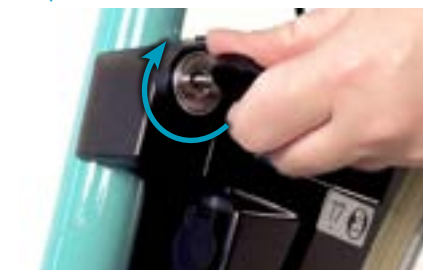
Punto 4 Bloquear la batería
