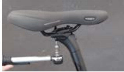
Punto 1 Aflojar los tornillos
