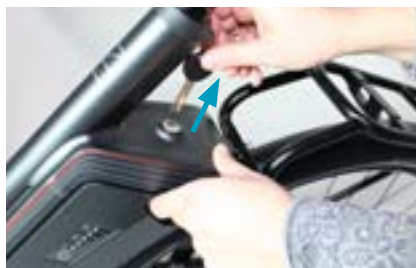
Punto 4 Bloquear la batería
