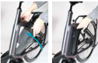
Punto 3 Deslizar la batería en la estación de acoplamiento
