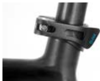
Punto 2 Palanca de cierre rápido cerrada
