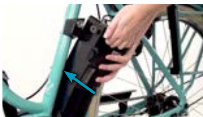
Punto 3 Deslizar la batería en la estación de acoplamiento
