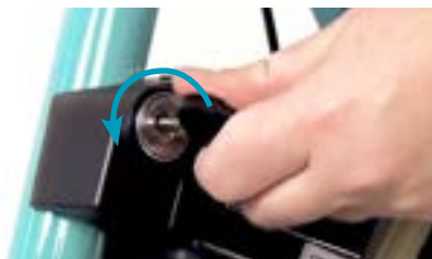
Punto 1 Desbloquear la batería
