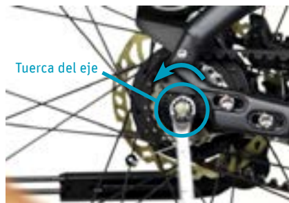
Punto 4 Afloje las tuercas del eje
