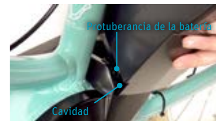
Punto 2 Protuberancias de la batería en la cavidad
