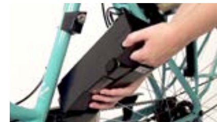
Punto 1 Sostener frente a la estación de acoplamiento
