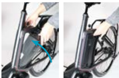
Punto 3 Deslizar la batería en la estación de acoplamiento
