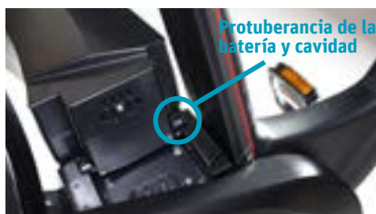
Punto 2 Protuberancias de la batería en la
