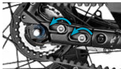
Punto 2 Aflojar los tornillos
