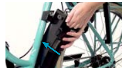
Punto 3 Deslizar la batería en la estación de acoplamiento
