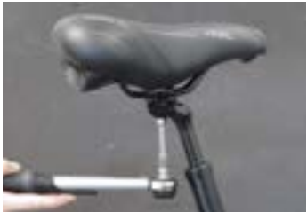
Punto 1 Aflojar el tornillo de fijación
