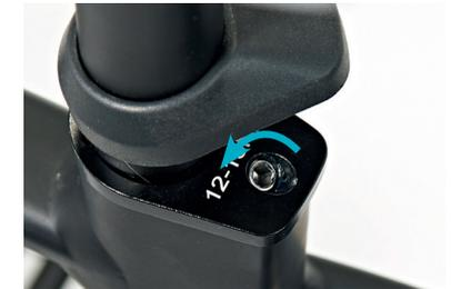
zu 1. Sattelschraube(n) lösen
