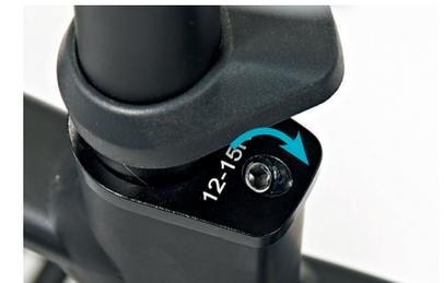
zu 3. Sattelschraube(n) festziehen
