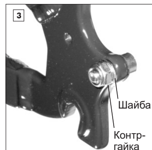
Опорный болт установлен, вид с внешней стороны рамы
