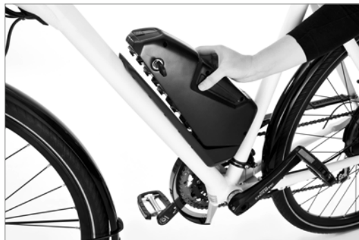
Colocación de la batería
