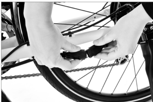
Desconexión del cable
