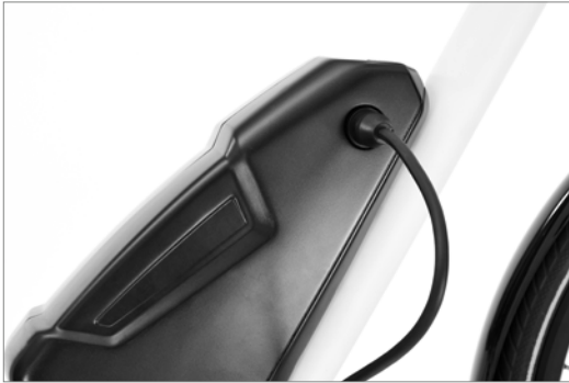
Aufladen der Batterie
