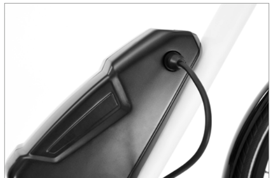
Aufladen der Batterie
