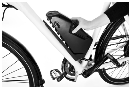
Mise en place de la batterie
