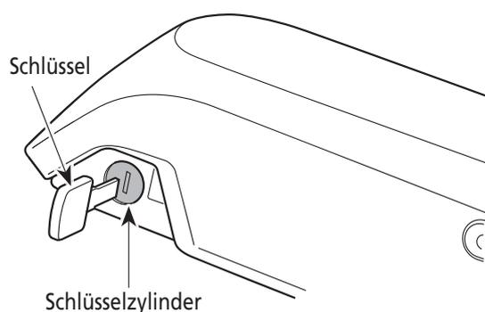
2. Zum Entriegeln des Akkus drehen Sie den Schlüssel nach links, bis Sie etwas Widerstand feststellen.
