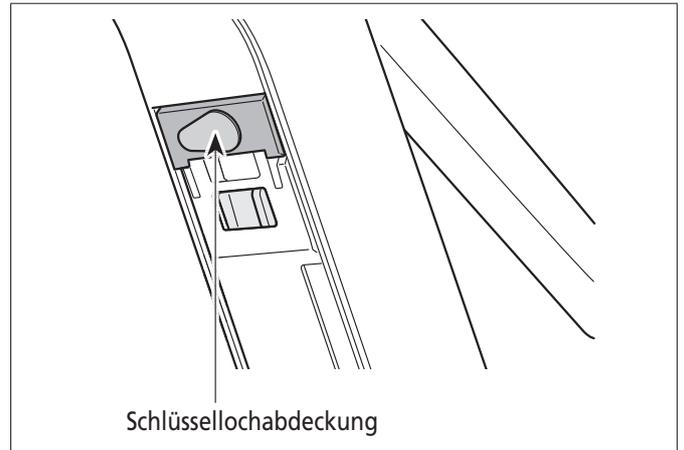
**2.** Führen Sie den Schlüssel in den Schlüsselzylinder in der Akkuhalterung ein.
