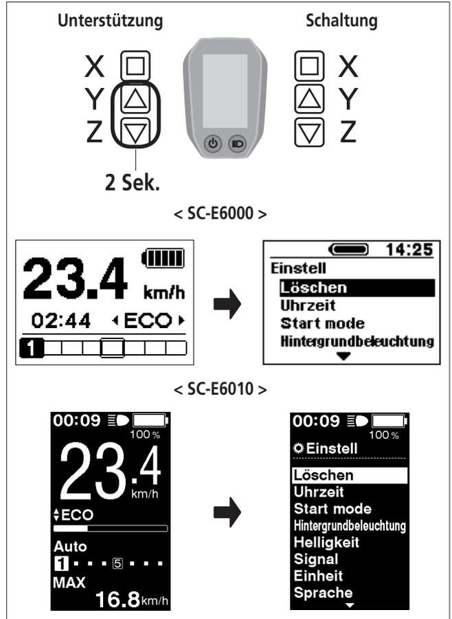
2. Drücken Sie Unterstützung-Y oder Unterstützung-Z, um den Cursor zu dem Element springen zu lassen, das Sie konfigurieren möchten. Durch Drücken von Unterstützung-X wird der Einstellbildschirm für das ausgewählte Element angezeigt.
