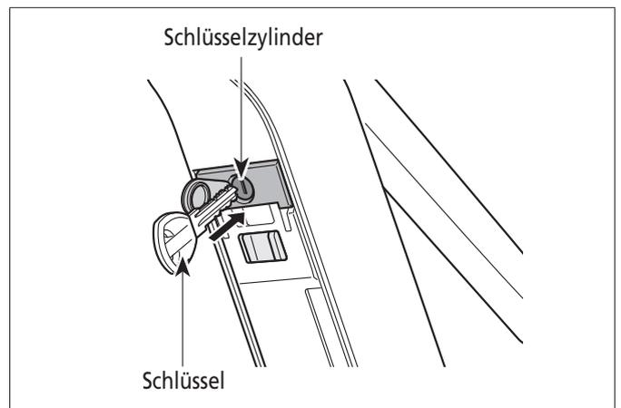
**3.** Der Akku löst sich automatisch, wenn der Schlüssel im Uhrzeigersinn gedreht und hineingedrückt wird.
