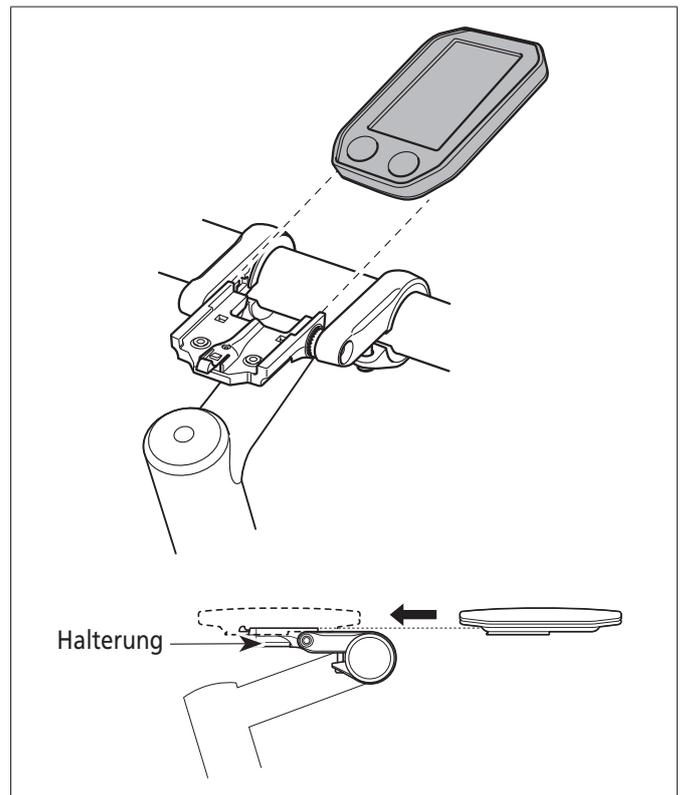
Um den Fahrradcomputer zu entfernen, drücken Sie fest auf den Hebel der Halterung, während Sie den Fahrradcomputer herauschieben.
