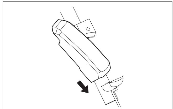
2. Schieben Sie den Akku vom Einsetzpunkt aus nach rechts. Drücken Sie den Akku hinein, bis er hörbar einrastet.
