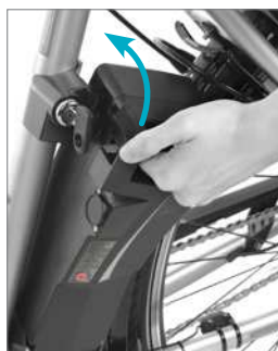
Colocación de la batería
