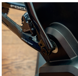
5. Attaccare il manicotto (2c) sul lato opposto alla trasmissione attraverso il forcellino.
