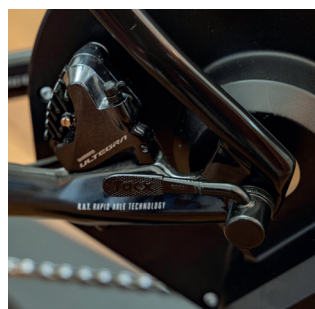
8. Non piegare la leva, stringere solo il perno passante.
