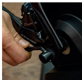
7. Stringere manualmente il perno passante quick release TACX finché non è ben stretto.
