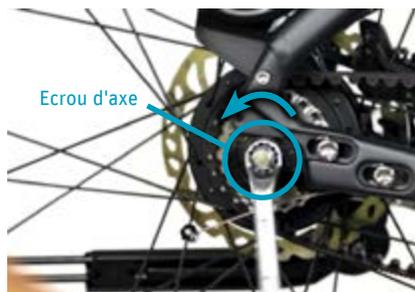
cf. 4. Desserrez l'écrou d'axe
