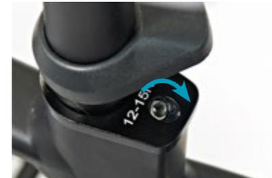
zu 3. Sattelschraube(n) festziehen
