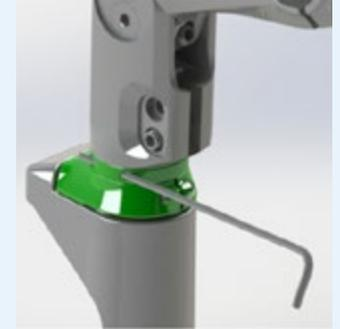
3. a) Steuersatz feststellen (Lagerspiel verringern): Drehen Sie den oberen Spacer so lange gegen den Uhrzeigersinn, bis er fest sitzt. Halten Sie gleichzeitig den unteren Spacer mit Daumen und Zeigefinger fest.
