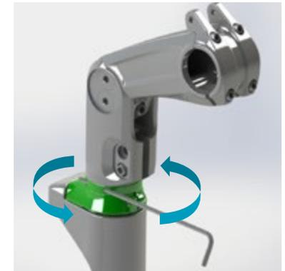
3. b) Steuersatz lösen (Lagerspiel vergrößern): Drehen Sie den oberen Spacer so lange im Uhrzeigersinn, bis das gewünschte Lagerspiel erreicht ist. Halten Sie gleichzeitig den unteren Spacer mit Daumen und Zeigefinger fest.
