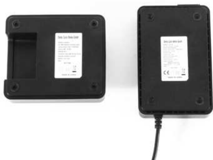
Plaques signalétiques sur le chargeur et le poste de charge
