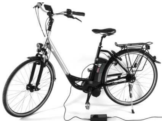
Chargement : batterie dans le Pedelec
