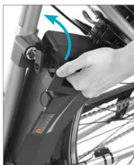
Remise en place de la batterie
