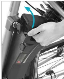
Mise en place de la batterie
