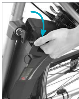
Basculer pour retirer la batterie
