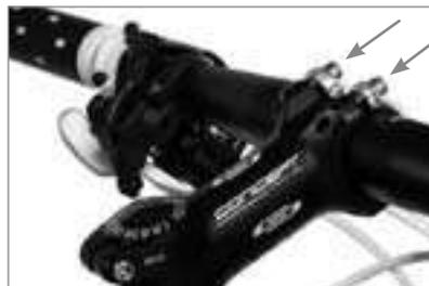
Après avoir réglé le guidon, ajustez les leviers de frein et de changement de vitesse. Desserrez les vis à six pans creux au niveau des bandes des poignées. Asseyez-vous sur la selle et posez les doigts sur le levier. Tournez le levier jusqu'à ce que votre main forme une ligne droite avec l'avant-bras. Resserrez les vis dans les bandes des poignées dans le sens des aiguilles d'une montre (pour les couples de serrage, voir ►► *Chapitre 30 « Données techniques »*).
