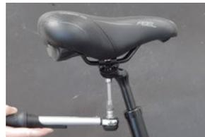
**Punto 1)** Rimozione della vite di bloccaggio
