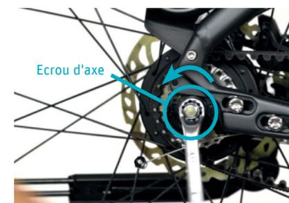
cf. 4. Desserrez l'écrou d'axe
