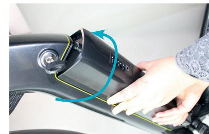
4. Tourner la clé de l'accumulateur dans le sens des aiguilles d'une montre. L'accumulateur est maintenant verrouillé.
