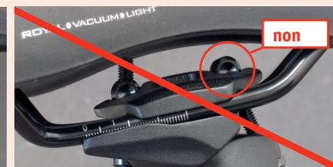
1. Pour faire glisser la selle, il faut dévisser les vis placées à l'avant et à l'arrière. Tournez dans le sens des aiguilles d'une montre. Les vis doivent au maximum faire deux à trois tours complets, sans quoi vous risquez de démonter tout le mécanisme.
