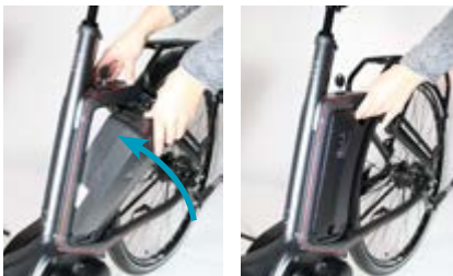
zu 3. Akku in die Dockingstation schieben
