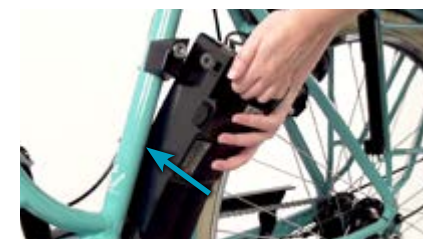
zu 3. Akku in die Dockingstation schieben
