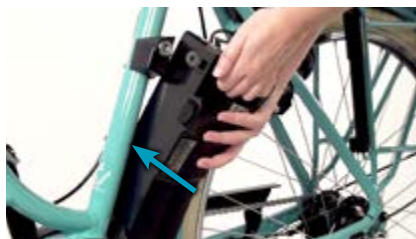
zu 3. Akku in die Dockingstation schieben
