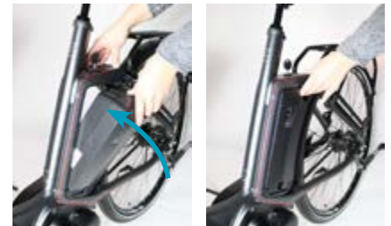
zu 3. Akku in die Dockingstation schieben
