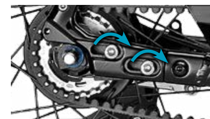
zu 4. Schrauben anziehen
