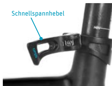
zu 1. Schnellspannhebel offen
