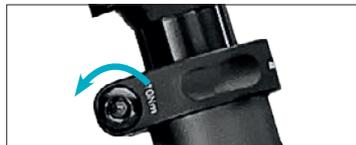
zu 1. Sattelschraube(n) lösen
