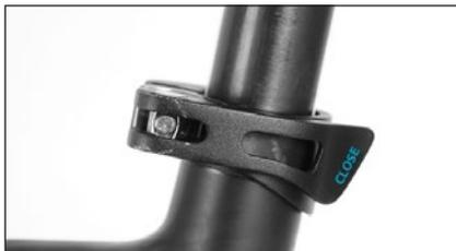
zu 3. Schnellspannhebel geschlossen
