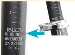
Auf der Sattelstütze ist markiert, bis wohin sie maximal aus dem Rahmen gezogen werden darf. Beachten Sie auch die Angaben des Rahmenherstellers, diese können ggf. abweichen. Die Sattelstütze nie weiter als bis zur Markierung aus dem Rahmen ziehen. Sie kann sonst abknicken oder brechen und Sie können schwer stürzen.
