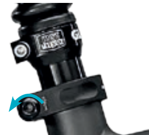
dot. pkt 1. Poluzować śrubę (-y) zaciskową (-e) siodełka
