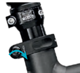
dot. pkt 3. Dokręcić śrubę (-y) zaciskową (-e) siodełka
