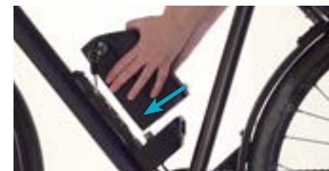
dot. pkt 2. Przytrzymać akumulator przy stacji dokującej
