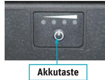
An der Außenseite des Akkus befindet sich ein Anzeigefeld mit vier LEDs und einer Akkutaste. Sobald Sie auf die Akkutaste drücken, leuchten die LEDs blau auf. Anzahl und Art des Aufleuchtens geben Informationen über den Akku.
