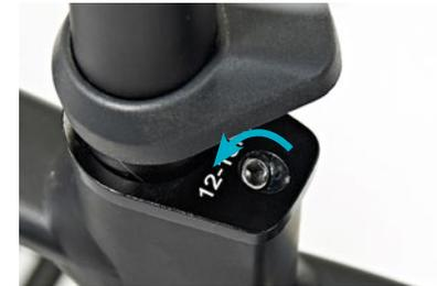
zu 1. Sattelschraube(n) lösen
