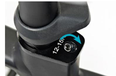
zu 3. Sattelschraube(n) festziehen
