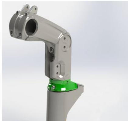
6. Ziehen Sie die M4-Schraube mit 2 Nm im Uhrzeigersinn an.
