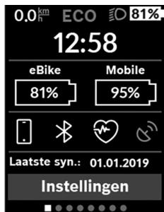
Op het statusscherm krijgt u naast de statusbalk de actuele tijd, de laadtoestand van alle accu's van uw eBike en de laadtoestand van uw smartphone-accu te zien, als de smartphone via Bluetooth® is verbonden.
