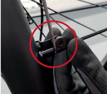
**7** Sostener el elemento de fijación de la varilla sobre el codo y marcar la intersección deseada de la varilla con un objeto puntiagudo.
