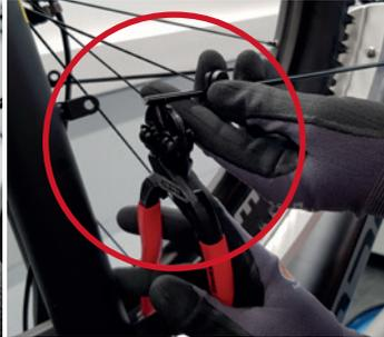
**8** Cortar la varilla en la marca con un cortaalambres o sierra para metales y desbarbar después.
