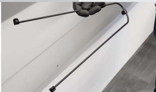
**5** Poner los elementos de fijación de la varilla del guardabarros en la varilla.
