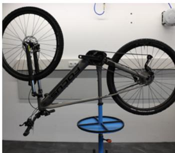
**1** Fijar la bicicleta boca abajo en el soporte de montaje.
