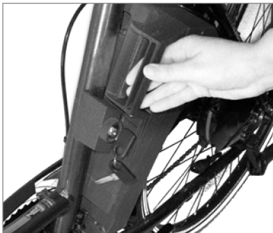
Mise en place de la batterie
