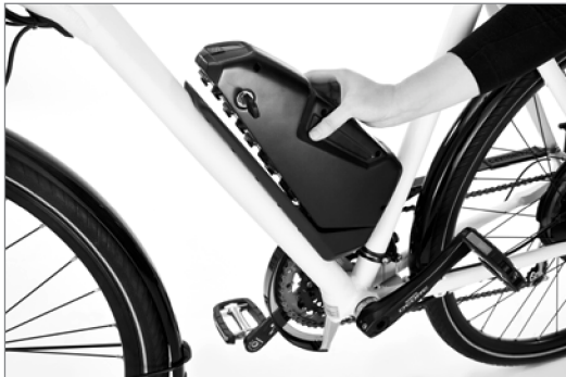
Mise en place de la batterie
