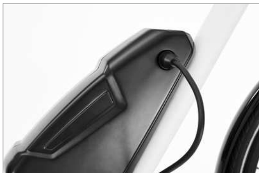
Aufladen der Batterie
