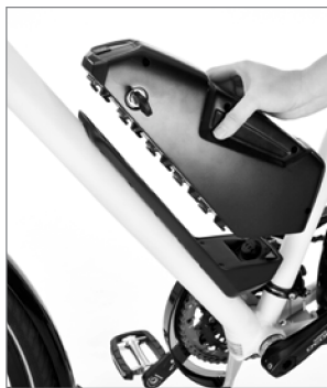
Mise en place de la batterie
