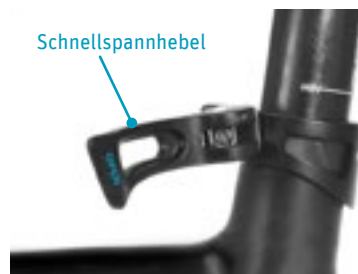
zu 1. Schnellspannhebel offen
