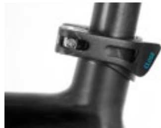
zu 2. Schnellspannhebel geschlossen
