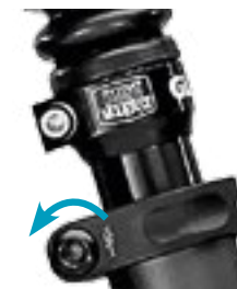
zu 1. Sattelklemmschraube(n) lösen
