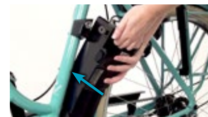
zu 3. Akku in die Dockingstation schieben
