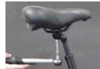
zu 1. Klemmschraube lösen
