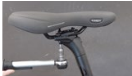
zu 1. Schrauben lösen
