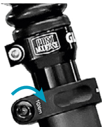
bij 3. Zadelklembout(en) vastdraaien
