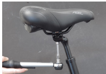
bij 1. Klemschroef losmaken
