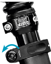
bij 1. Zadelklembout(en) losdraaien
