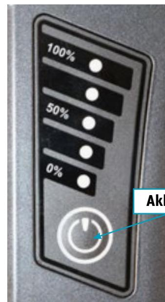
An der Außenseite des Akkus befindet sich ein Anzeigefeld mit fünf LEDs und einer Akkutaste. An drei LEDs sehen Sie Prozentangaben. Sobald Sie auf die Akkutaste drücken, leuchten die LEDs auf. Anzahl und Art des Aufleuchtens geben Informationen über den Akku.
