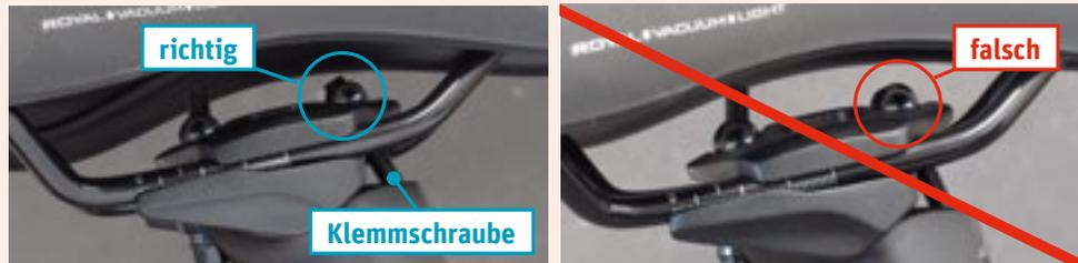
1. Um den Sattel zu verschieben, vordere und hintere Schraube lösen, indem Sie diese gegen den Uhrzeigersinn drehen. Drehen Sie die Schrauben höchstens zwei bis drei Umdrehungen auf, sonst kann der gesamte Mechanismus auseinanderfallen.
