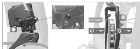
Abb. 96 Oberen Anschlag einstellen ©Sram
