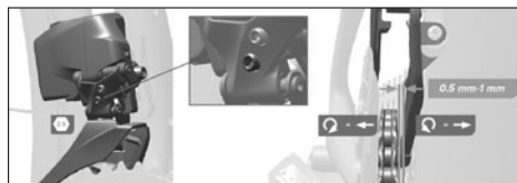
Abb. 97 Oberen Anschlag einstellen ©Sram
