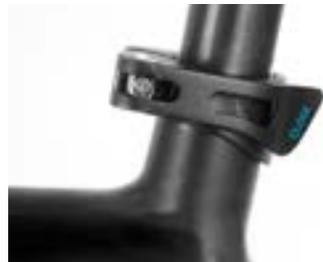
zu 2. Schnellspannhebel geschlossen
