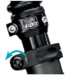
zu 1. Sattelschraube(n) lösen.
