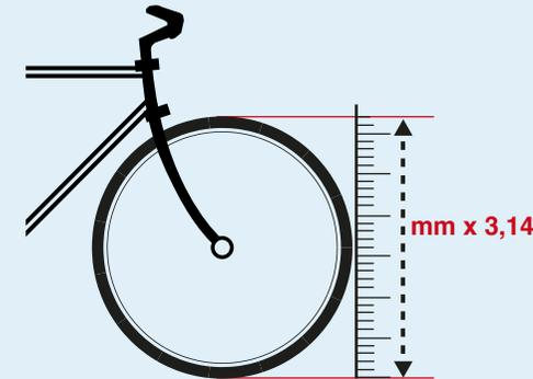
2. Oder lassen Sie das Rad mit einer Umdrehung abrollen und messen Sie die zurückgelegte Distanz in mm nach.
