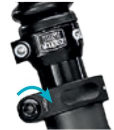
zu 3. Sattelschraube(n) festziehen.
